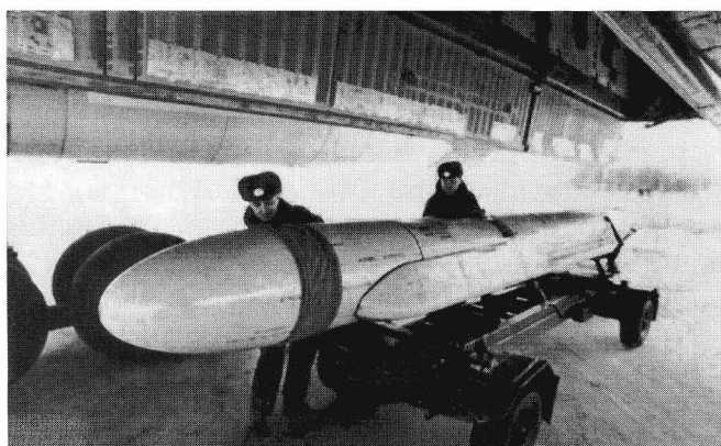
Подвеска крылатой ракеты в отсек Ту-160
