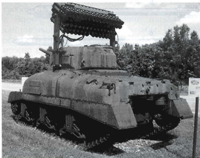
Укороченная пусковая установка ракет М8 на танке "Шерман"
