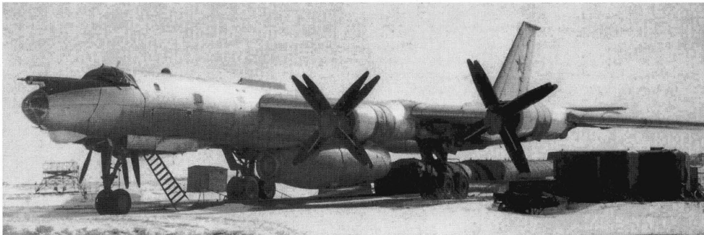
Летающая лаборатория Ту-142ЛЛ с двигателем для Ту-160 под фюзеляжем
