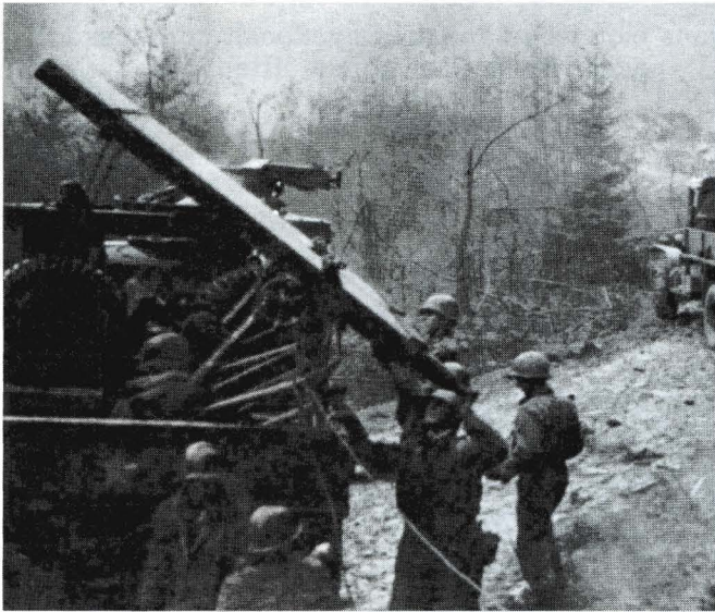
Американская пусковая установка для ракет М8 на базе грузовика
