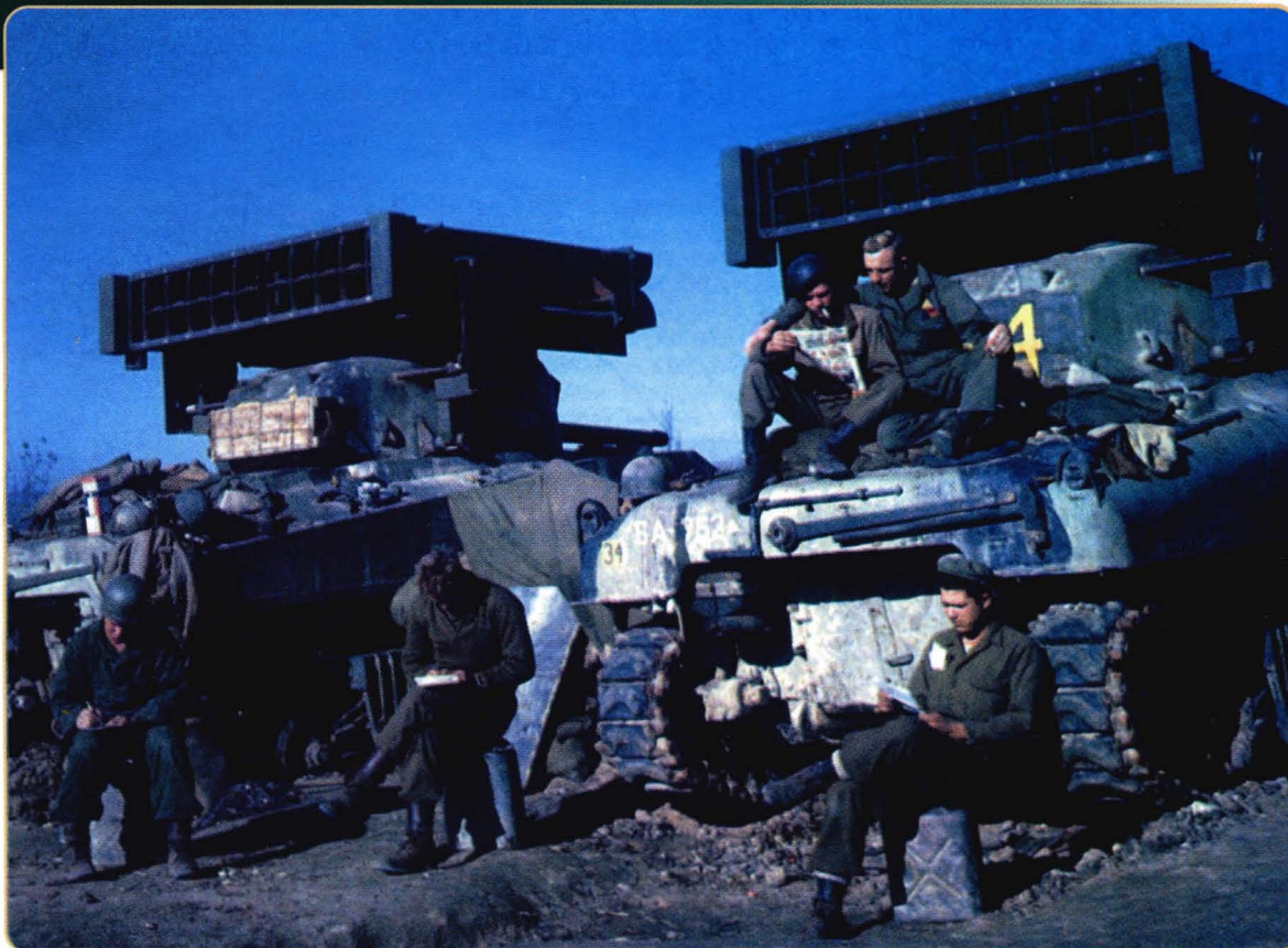
Пусковые установки ячеистого типа, установленные на американских танках «Шерман»
